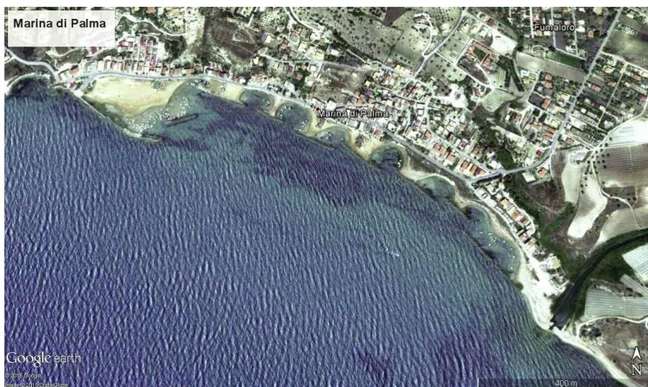
Fig. 8 — Spiagge di tombolo recentemente formatesi nei pressi di Marina di Palma a seguito della posa di barriere frangiflutti. In alto a sinistra è visibile il risultato del processo di insabbiamento dell'infrastruttura portuale, conseguente alla messa in posa della struttura di sbarramento (immagine da satellite; fonte [www.google.it/intl/it/earth/](http://www.google.it/intl/it/earth/)).
